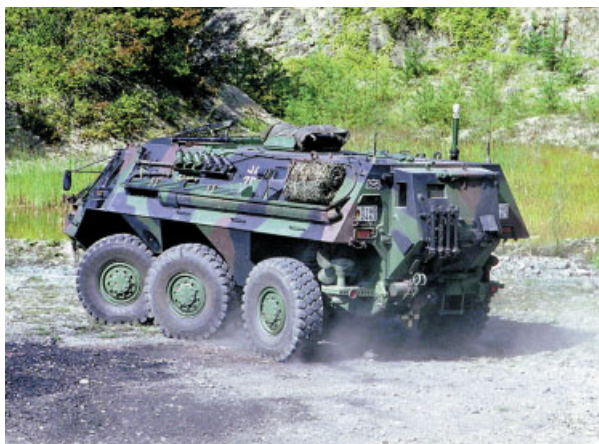
Abb. 4 Der Spürpanzer FUCHS kann Kampfstoffe über eine GC-MS-Kopplung feststellen und ihre Ausdehnung aufgrund von Wetterdaten berechnen. [mit freundlicher Genehmigung der Firma Rheinmetall-Detec]
